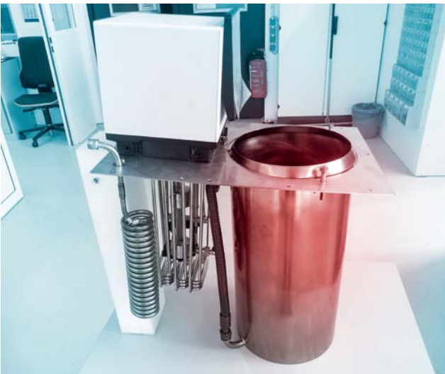
图 2： 安装Universa MAX 泵控制单元的浴槽桥架
